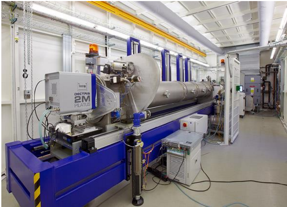
Рис. 1.3. Малоугловая станция P12 накопительного кольца Petra III, синхротрон DESY (Гамбург, Германия).
