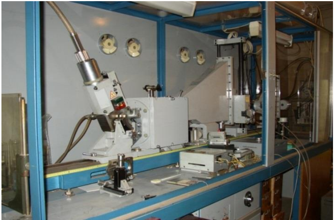
Рис. 1.2. Установка малоуглового рассеяния АМУР-К (Институт кристаллографии РАН).
