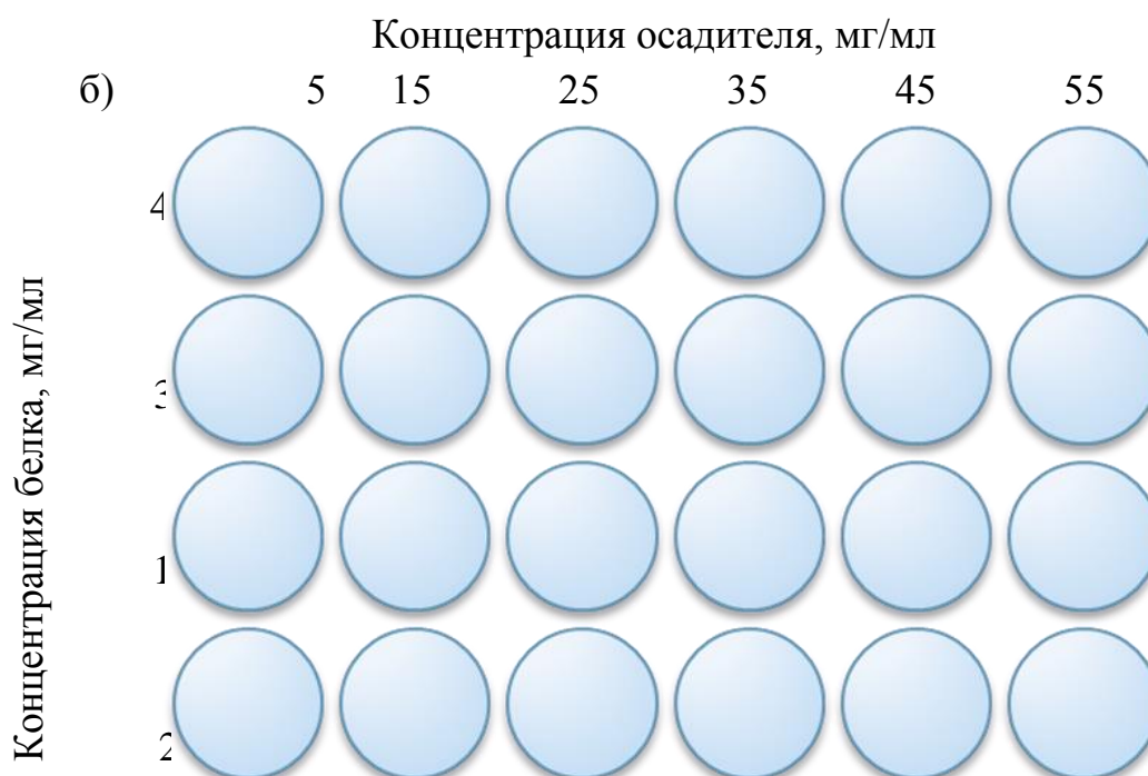
Рис. 2.14. а) Пластика для кристаллизации методом диффузии в парах Hampton research; б) Схема эксперимента по скринингу условий кристаллизации в пластике.
