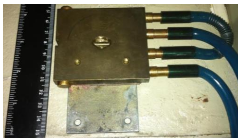
Рис. 2.21. Специальная термостатируемая ячейка, подключенная к водяному термостату, для исследования белковых растворов при различных кристаллизационных условиях.
