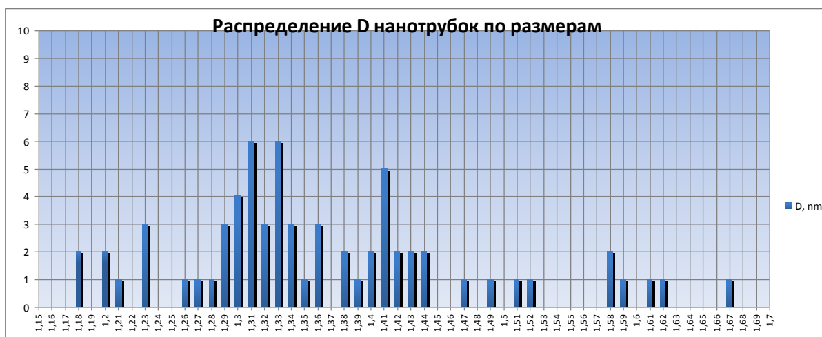
Рис. 2.2. График распределения диаметров ОСУНТ по размерам, полученных методом каталитического электродугового синтеза. Измерено более 70 нанотрубок.
