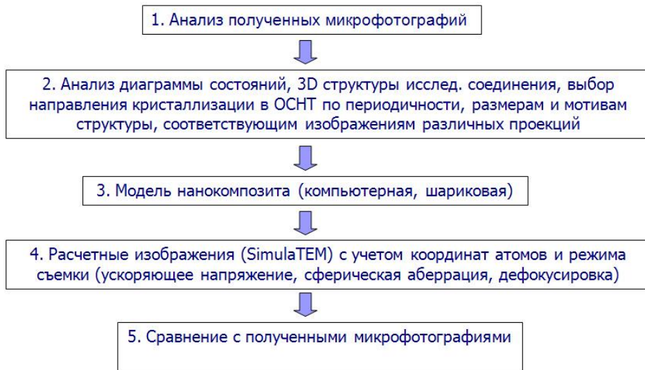
Рис. 2.12. Схема получения модели 1D кристалла в канале ОСУНТ.
