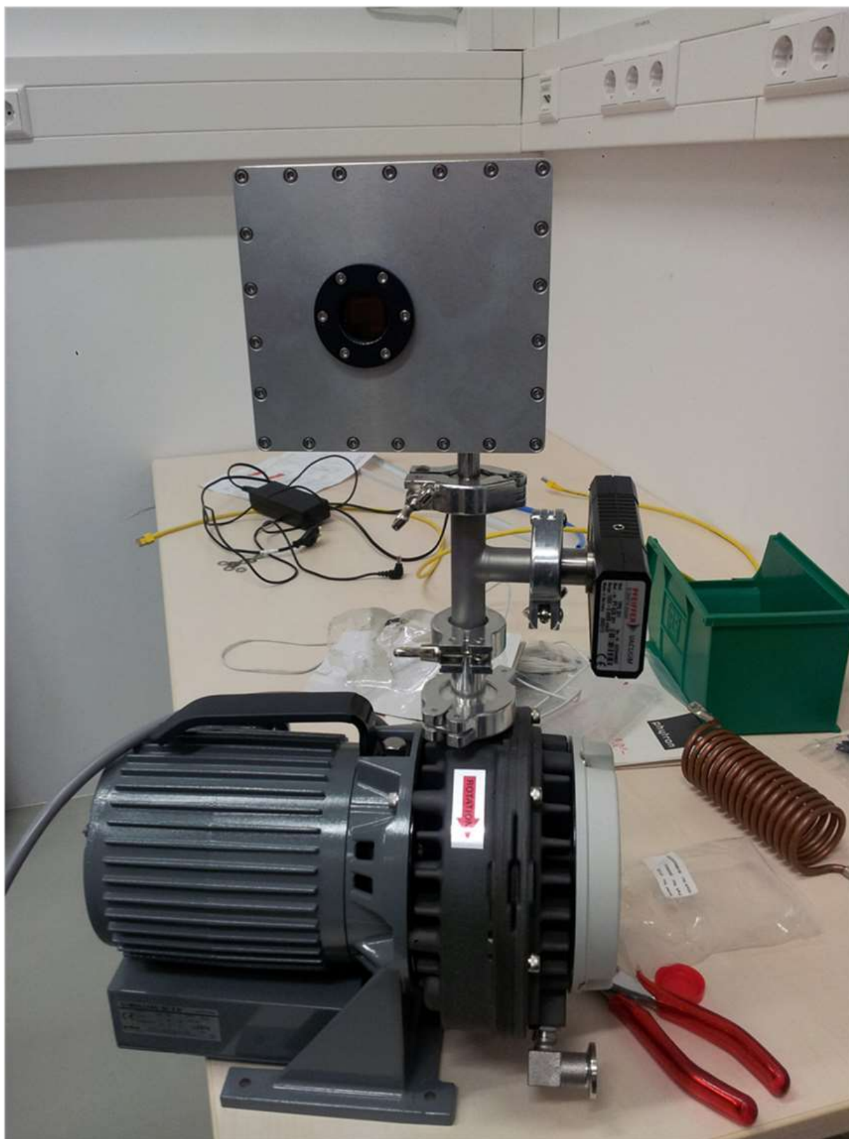
Рисунок 1.5. Высокоскоростной рентгеновский детектор разрабатываемый для станции ТороТото синхротронного источника ANKA (Германия).
