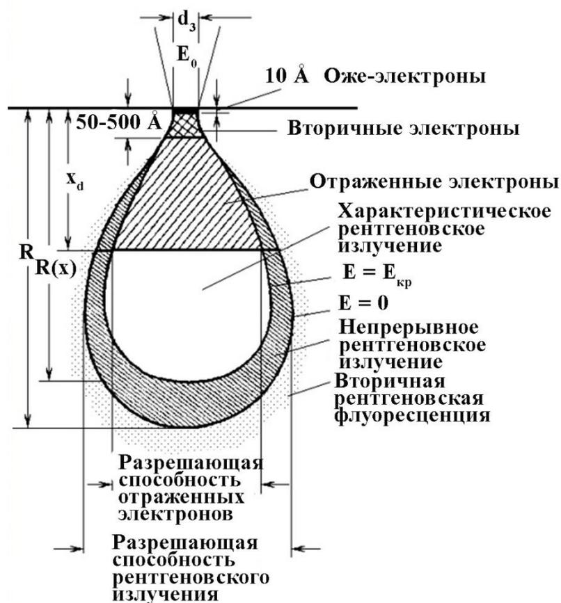
Рисунок 26 – Общий вид области взаимодействия электронного зонда с образцом:  $E_0$  – энергия электронного зонда,  $d_3$  – его диаметр,  $E$  и  $E_{кр}$  – энергия электронов, образующих тормозное и характеристическое излучение, соответственно,  $x_d$  – глубина, в пределах которой формируются отраженные электроны,  $R$  – предельная глубина образования флуоресцентного излучения,  $R(x)$  – предельная глубина образования тормозного рентгеновского излучения
