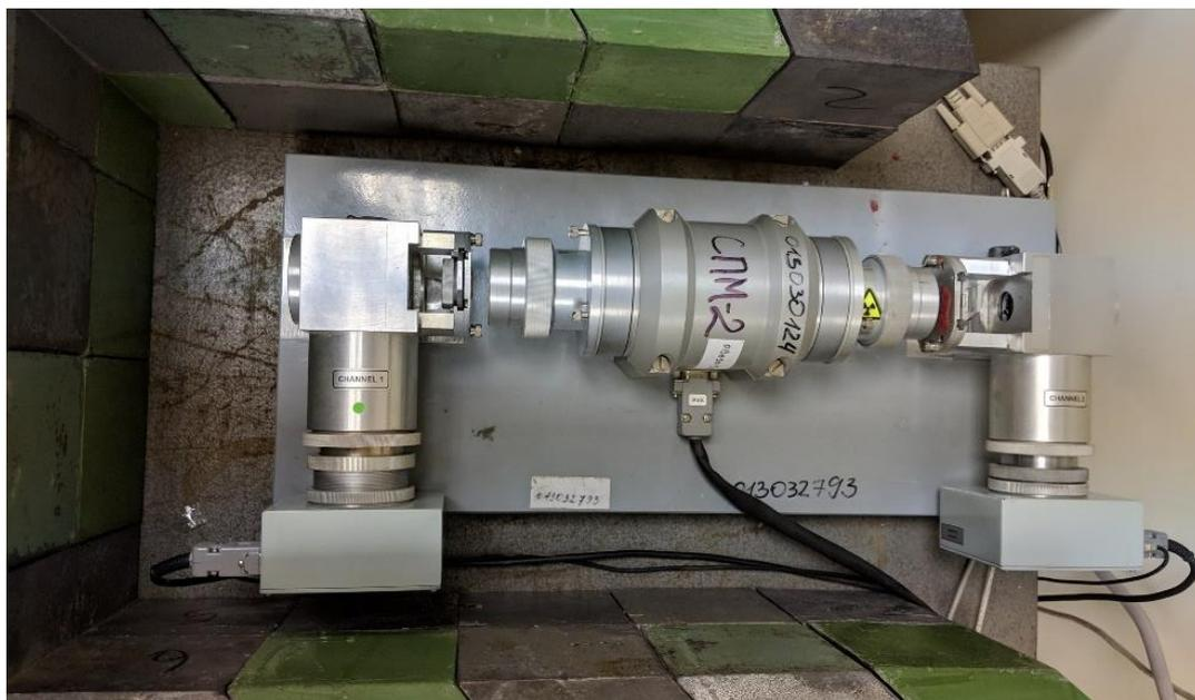
Рисунок 2.3. Спектрометр MS-1104Em для измерения образцов при комнатной температуре с двумя каналами для измерений.
