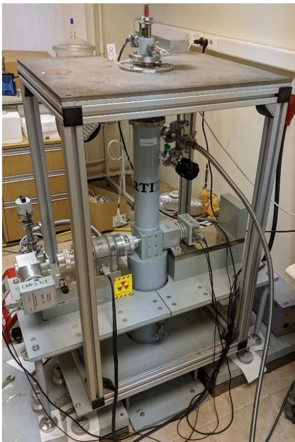
Рисунок 2.4. Мессбауэровский спектрометр с гелиевым безжидкостным криостатом замкнутого цикла для измерений в диапазоне температур 5 – 300 К.
