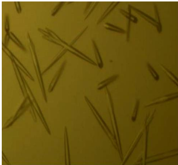
Рис.2.22 – Кристаллы термолизина гексагональной сингонии, выращенные в растворе с концентрацией белка C_b = 25 мг/мл и концентрацией осадителя C_{oc} = 0,75 М.
