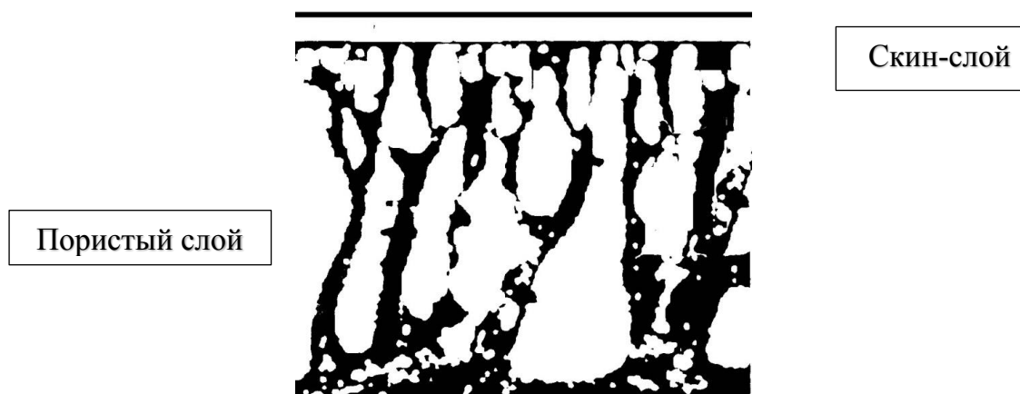
Рис.5.2. Схематическая изображение структуры подложки типа ПАИ.
