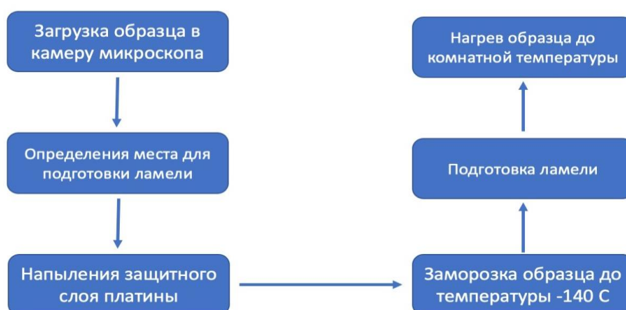
Рис. 3.16. Схема эксперимента подготовки образца методом двулучевой криогенной РЭМ.
