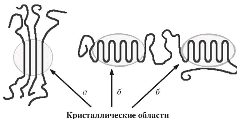
Рис. 1.3. Фибриллярная и складчатая структуры: а — фибриллярная структура; б — складчатая структура
