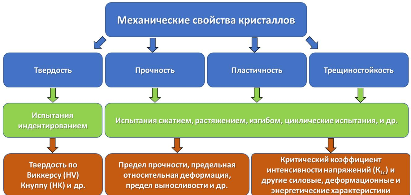
*Рисунок 1. Механические свойства кристаллов (выделены синим), основные виды механических испытаний (выделены зеленым) и свойства, которые определяются в ходе этих испытаний (выделены оранжевым).*
