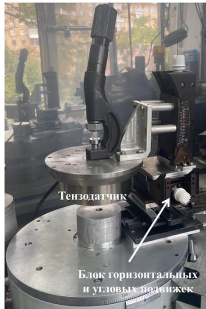
*Рисунок 32. Фотография компактного гидравлического пресса, установленного на дифрактометр на гониометр образца.*
