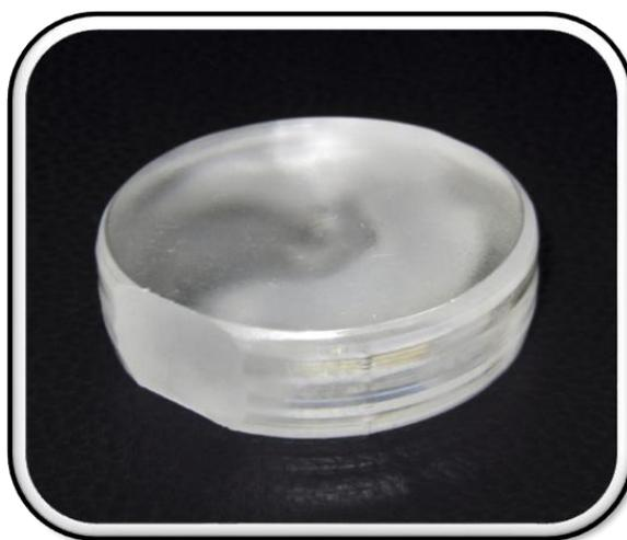
*Рис. 4.1. Исследуемый образец кристалла  $TeO_2$*
