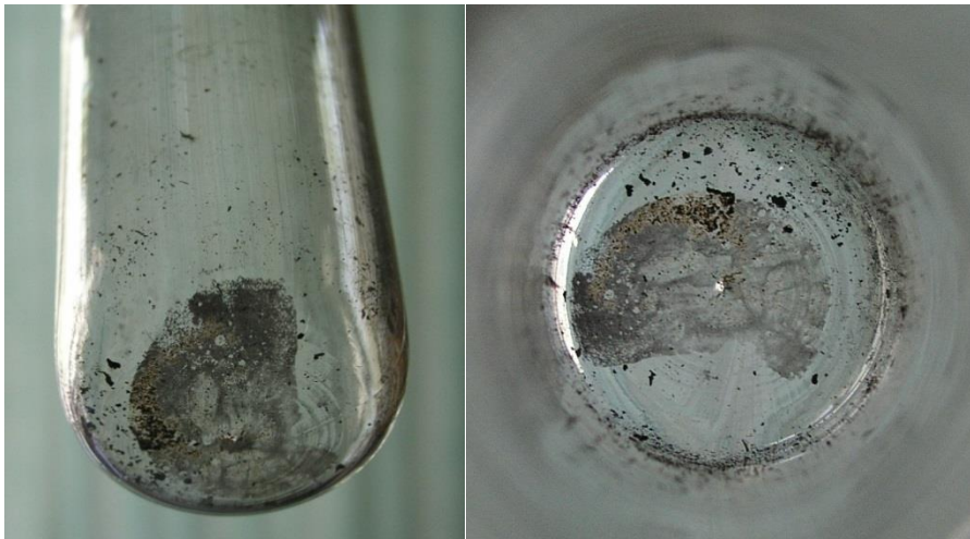
Рис. 2.7. Фотографии кубового остатка после дистилляции
