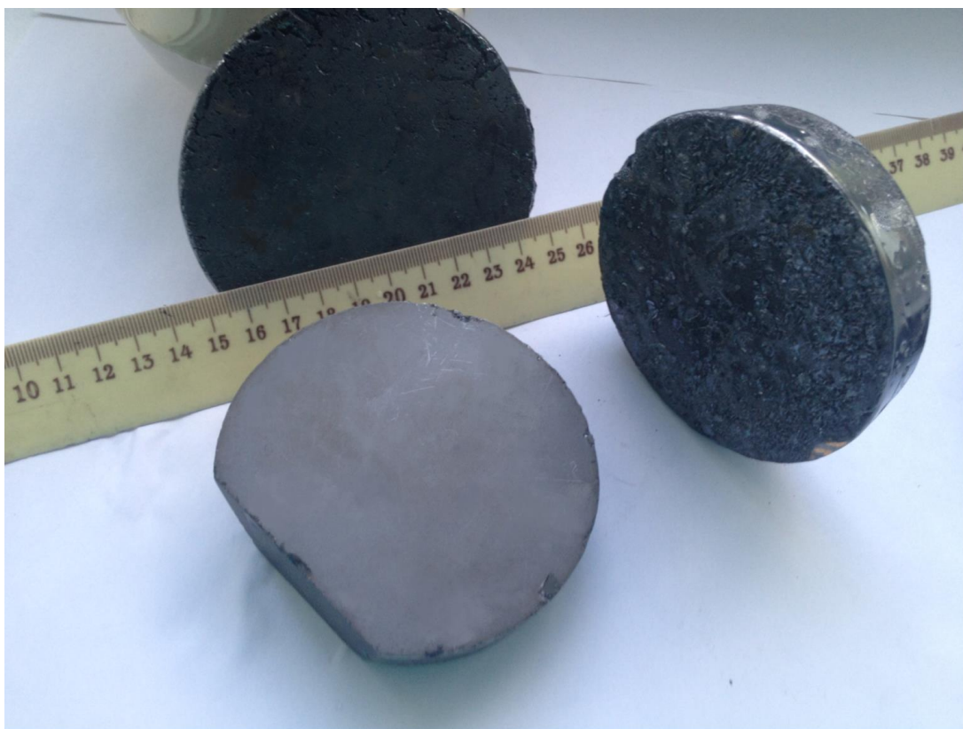
Рис. 4.2. Фотография выращенных модифицированным методом Обреимова-Шубникова монокристаллов CdTe и Cd 1-x Zn x Te
