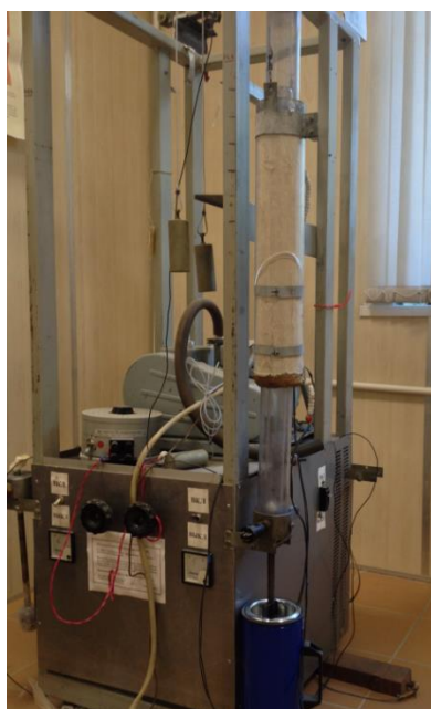
Рис. 2.4а. Установка многостадийной вакуумной дистилляции в процессе
