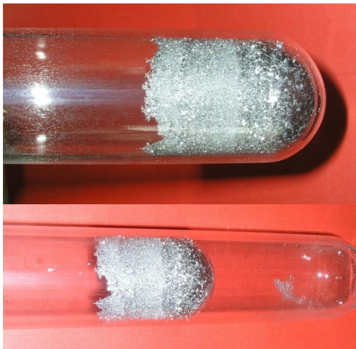
Рис. 2.8. Извлечение конденсата Cd из кварцевых ампул после дистилляции
