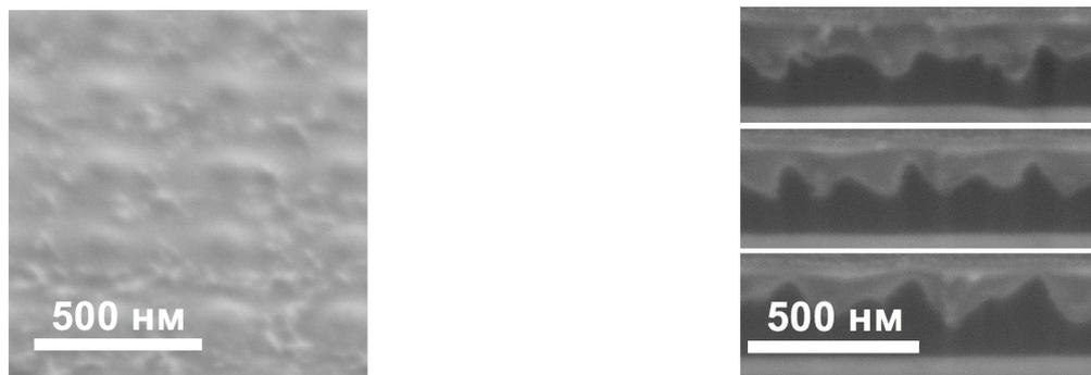
Рисунок 5.2 — Хиральная наноструктура в кремнии после термического окисления: а) РЭМ изображение фрагмента поверхности наноструктуры под углом  $52^\circ$  (рельеф исходной наноструктуры скрыт под слоем  $\text{SiO}_2$ ), б) три последовательных РЭМ изображения поперечных сечений наноструктуры под углом  $52^\circ$ , используемых для трехмерной реконструкции.
