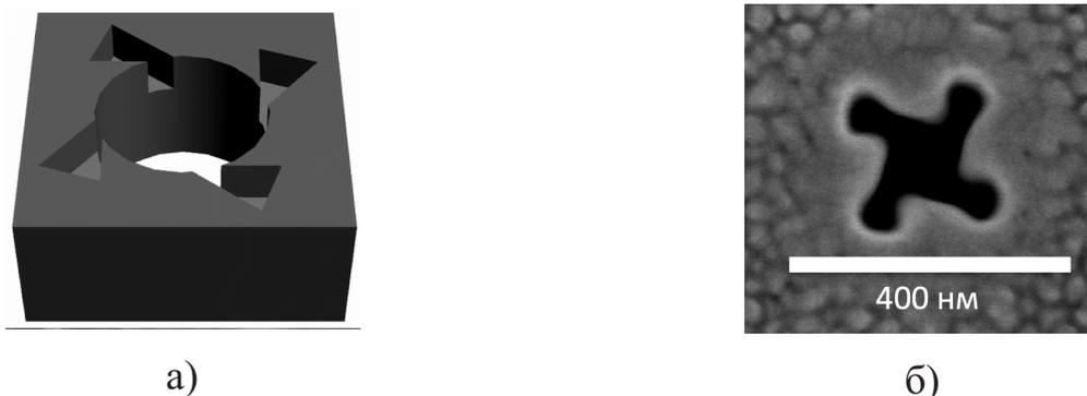
Рисунок 3.4 — Единичная 3D хиральная наноструктура диаметром 380 нм в поликристаллической золотой пленке толщиной 200 нм: а) 3D модель шаблона травления, б) РЭМ изображение
