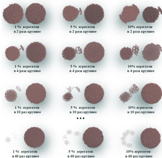
Рис. 3.14. Восстановление формы сферы диаметром 10 нм в присутствии агрегатов разных размеров с разным их содержанием в образце. Восстановленные формы показаны попарно: слева восстановление по полной кривой, справа – по усеченной.
